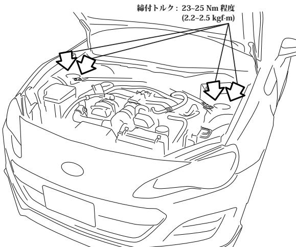
※注意 他社製タワーバー、補強プレースなどが装着されている場合、
