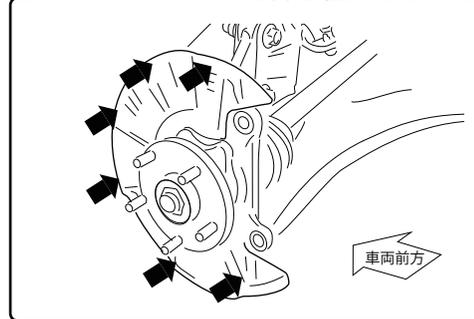
**注意：** ブレーキローターが干渉しないように曲げ加工してください。
