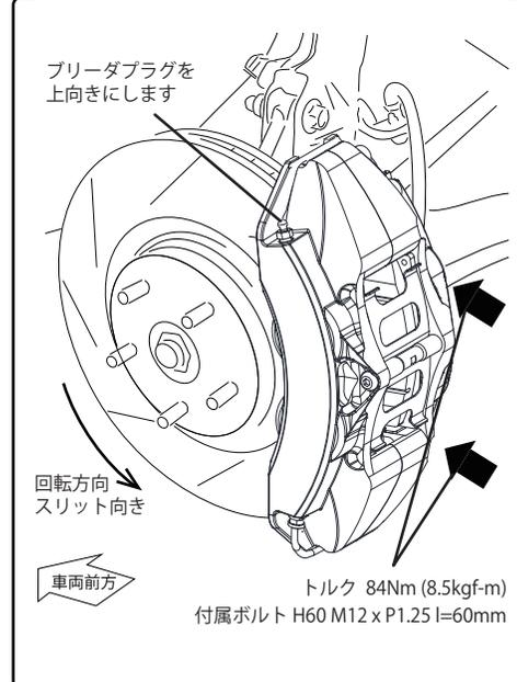
注意： ブレーキローターが干渉しないように曲げ加工してください。
